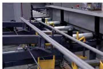
Positionnement de la barre dans l'axe de l'étau
